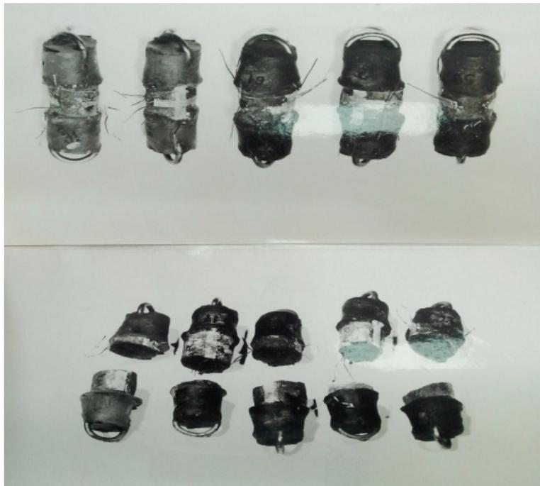
Рис. 2. Фотографии образцов керамзита до и после испытания на осевое растяжение
