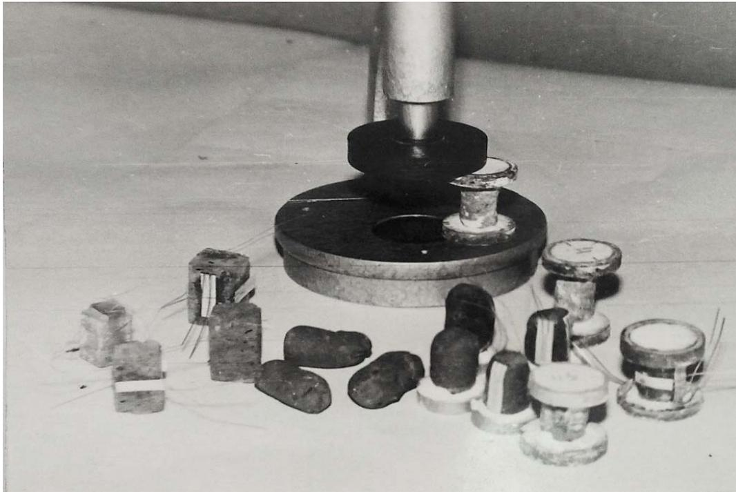
Рис. 1. Приспособление для изготовления опытных образцов керамзита
